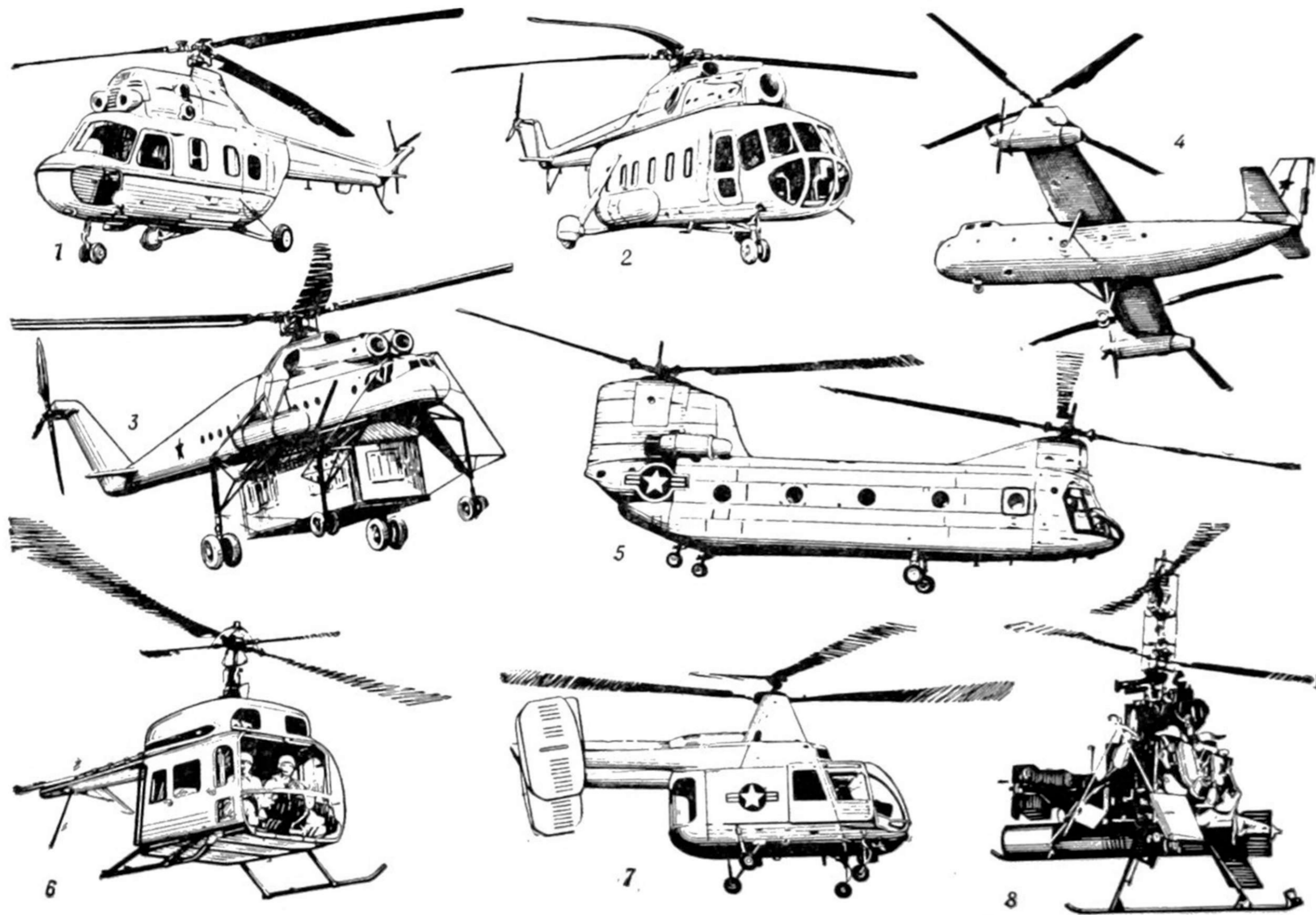
Вертолеты: 1. Легкий вертолет В-2 конструкции М. Л. Милья. 2. Пассажирский вертолет В-8 конструкции М. Л. Милья. 3. Тяжелый вертолет — летающий кран конструкции М. Л. Милья с подвешенным под фюзеляжем переносным домом. 4. Тяжелый винтокрыл Ка-22 конструкции Н. И. Камова. 5. Тяжелый транспортный вертолет Вертол УНС-1 В «Чинук». 6. Легкий транспортный вертолет Хиллер 10-99. 7. Легкий транспортный вертолет Каман Н-43 В «Хаски». 8. Радиоуправляемый противолодочный вертолет Джиродайн DS № 1.
